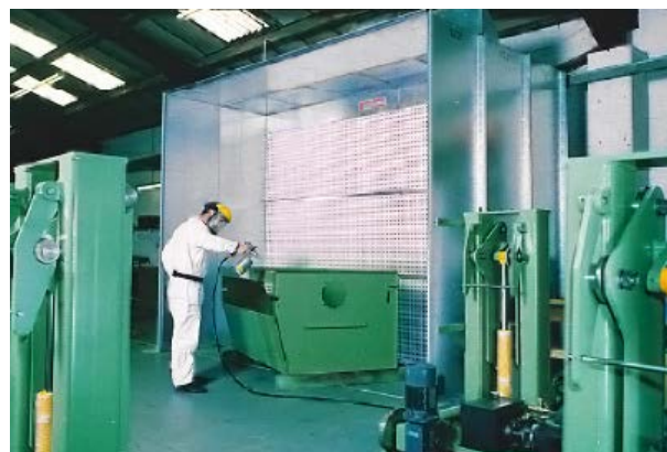
代表的な3段ドライフィルタースプレーブース
